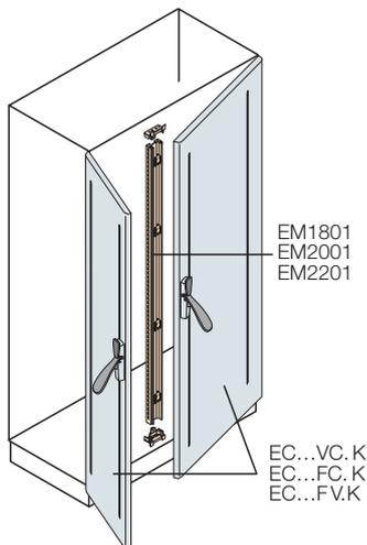
Монтаж глухих дверей, закрываемых внахлест (без передней вертикальной стойки и поперечных профилей, устанавливаемых по глубине)
