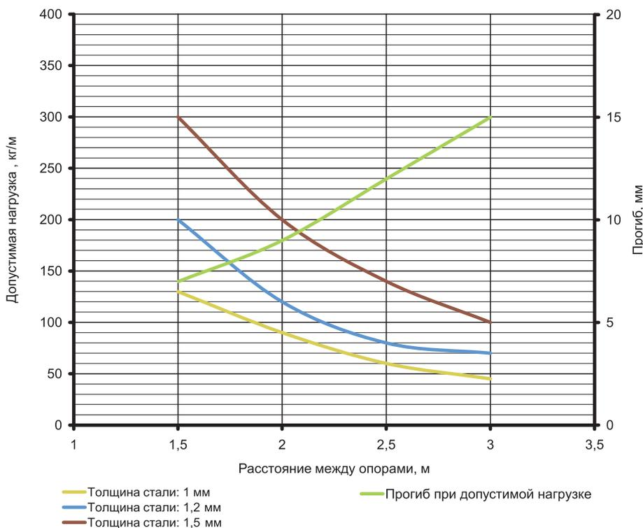
**Условия испытаний лотков на безопасную рабочую нагрузку:**
