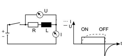
При подаче напряжения на катушку образуются электродвижущая сила, и нарастание тока происходит с задержкой по времени. При прекращении подачи напряжения на катушку происходит скачкообразное уменьшение величины магнитного поля, которое в свою очередь, вызывает всплеск напряжения обратной полярности на катушке. Этот всплеск может достигать значений, в 15 раз превышающих номинальное напряжение, что может помешать нормальной работе электронных устройств, вплоть до их разрушения.
